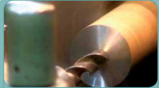
Herramienta estática gira la pieza
