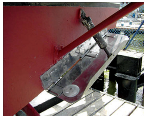
Figura 3.18. Casco de barco protegido con ánodo de sacrificio de aleación de aluminio.
