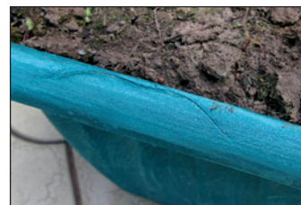
Figura 5.11. Weathering sufrido por una maceta de PP expuesta a la intemperie durante 10 años. Se observan fisuras, decoloración y cambios en la textura del material.
