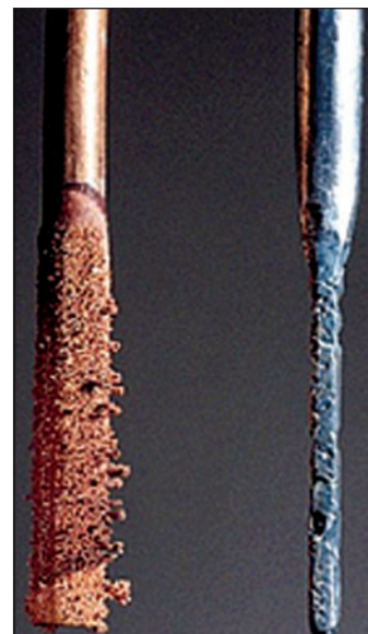
Figura 3.15. Electrodos de cobre y cinc luego de haber estado cortocircuitados en la pila de Daniell un tiempo prolongado. Se nota cómo se engrosó la barra de cobre en su parte sumergida en la solución de CuSO_4 (inferior) por el depósito de Cu desde la solución y cómo se adelgazó la barra de cinc por corrosión.
