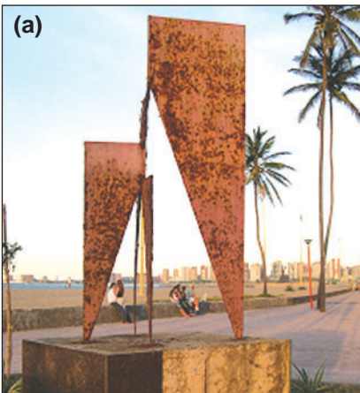
Figura 1.6. Degradación (corrosión atmosférica) de piezas metálicas expuestas a un ambiente marino. (a) Obra escultórica metálica; (b) Amarre costero. Fortaleza, Brasil.
