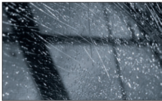
Figura 5.12. Crazing sobre un parabrisas de automóvil fabricado de policarbonato.
