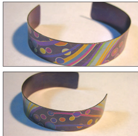
Figura 3.20. Pulsera de titanio anodizado. Cada color corresponde un espesor diferente de óxido crecido a diferentes potenciales mientras el resto de la superficie permanecía cubierta por una laca.
